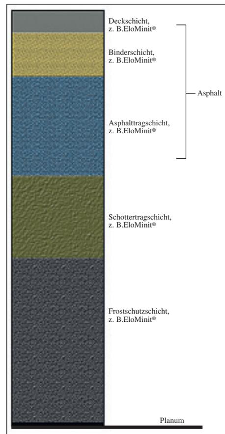
Beispielhafter Aufbau des Straßenoberbaus mit Kennzeichnung der Einsatzmöglichkeiten für EloMinit®
