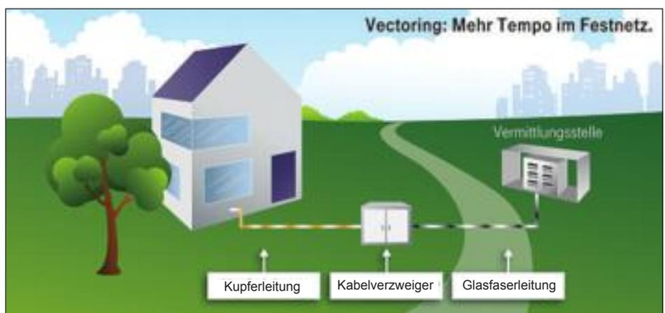
Durch Vectoring werden die elektromagnetischen Störungen ausgeglichen, die es zwischen den Kupferleitungen auf dem Weg in die Haushalte gibt. Das ermöglicht mit Geschwindigkeiten von bis zu 100 Mbit/s deutlich schnellere Datenübertragungen. Die Technik dafür wird in den Kabelverzweigern installiert.
