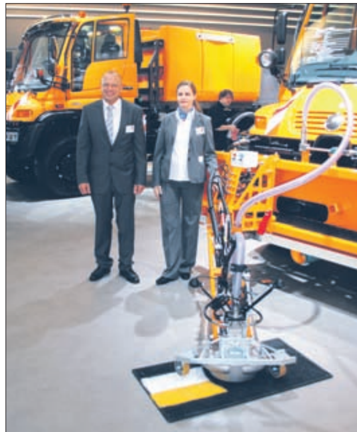
Birgit Strobel (Vertrieb Mercedes-Benz Trucks) und Dirk Lehmbeck (Marketing Mercedes-Benz Trucks) vor einem Unimog U 500, beispielhaft ausgerüstet mit Demarkierungsgerät auf der IFAT ENTSORGA 2012 in München. Das Peeljet Unimog Modul von Weigel Hochdrucktechnik ist als Anbaugerät für die Entfernung von Farbmarkierungen konzipiert.
