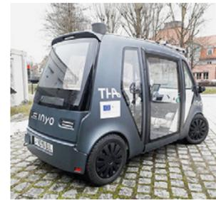
Ein Prototyp der automatisierten Shuttle-Fahrzeuge aus dem Projekt NeMo.bil. Bild: Jessica Hövelborn/THA
