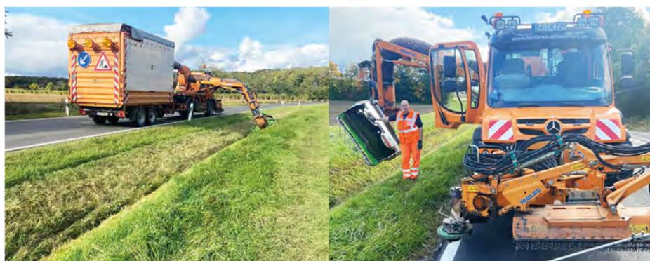
Mähzug mit Randstreifenmäher und Leitpostenausmäher am Unimog U 400 mit absaugendem Heckaufsatzgerät SB 600 und Grasaufnahmeanhänger, Fahrer: Thomas Gößmann Bilder: Stefan Dülk
