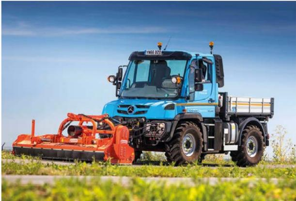
Mercedes-Benz Unimog U218; Stark im Grünen: Dank Frontzapfwelle, drei Differenzialsperrern und permanentem Allradantrieb entpuppt sich der U 218 als Tausendsassa. Bild: media.daimler.com
