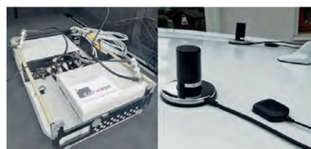
Abb. 2: Professionelles Mess-Equipment von „Rohde & Schwarz“, Autodach-Antennen auf dem Messfahrzeug für die Vermessung der Straßen.
