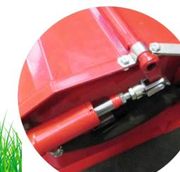
GF3x1Plus, Einfaches Umschalten mittels Hydraulikzylinder zwischen Mähen mit Aufsammeln oder Mähen und Ablegen. Die bewegliche Platte gibt den Weg für das Mähgut zum Aufsammeln frei oder leitet es direkt auf den Boden ab.
