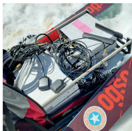
Abb. 3: geöffneter Mess-Rucksack mit den Mess- und GPS-Antennen im alpinen Einsatz.
