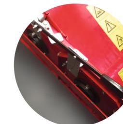
Beim TURBO1 ist die Umschaltung zwischen Aufsammeln und Ablegen **mechanisch**. Ein handlicher Hebel ersetzt den Hydraulikzylinder der PG-Version, die Bedienung erfolgt links am Gerät.
