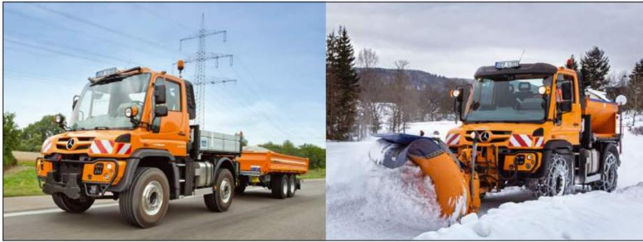
Der Unimog U 323, das neue Top-Modell der Unimog-Mittelklasse (300er Baureihe) von Mercedes-Benz, hat mit 170 kW (231 PS) nicht nur mehr Leistung; der neue U 323 wird auch in den beiden Radständen 3000 und 3600 Millimeter und mit einem maximalen zulässigen Gesamtgewicht von 14,0 Tonnen angeboten. □
