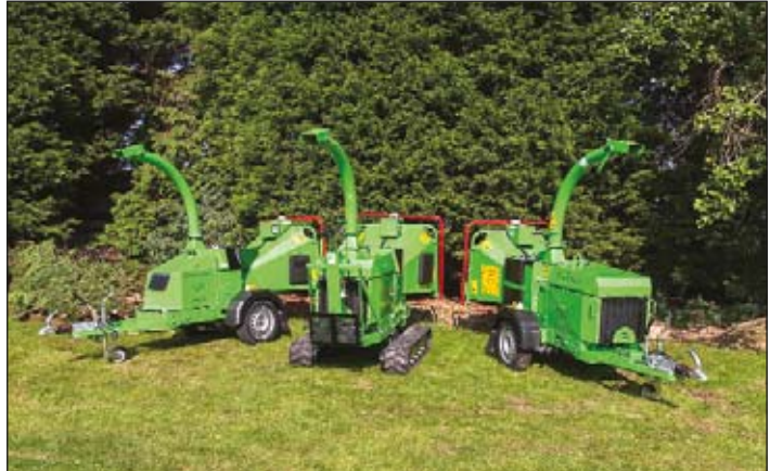
V. l.: Die Anhänger-Häcksler Arborist 130, ArbTrak 150 und Arborist 150 von GreenMech sind einfach zu bedienende Häcksler für Baumschnitt bis 16 cm Durchmesser. □
