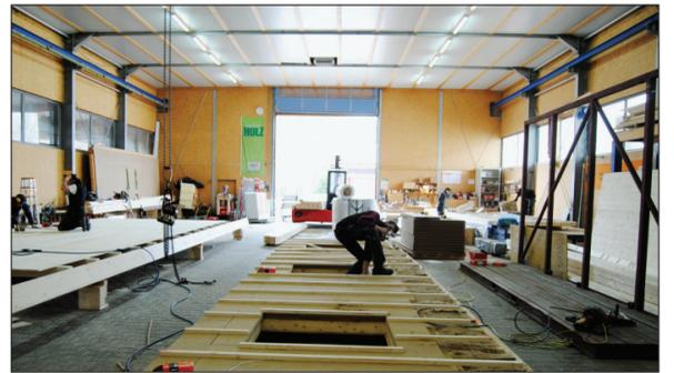
In der Werkstatt von Holzbau Wöndl wurden die Wände der Häuser vorgefertigt, was unter anderem den schnellen Bau vor Ort ermöglicht.
