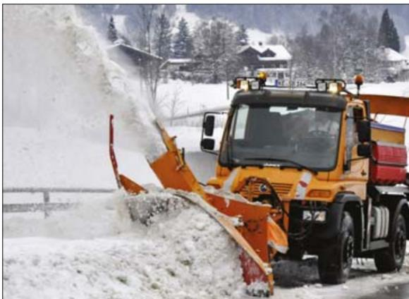
**Ein Meter hoher Schnee auf der Fahrbahn? Der Unimog U 500 hat damit kein Problem. Sein 286-PS-Triebwerk treibt den Mercedes-Giganten durch die schweren Massen.**
