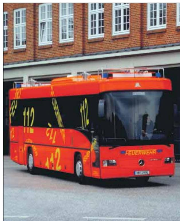
Der neue Einsatzleitwagen der Hamburger Feuerwehr auf Basis des Überlandbusses Mercedes-Benz Integro fällt mit seiner Folienbeklebung bereits optisch deutlich auf. Am Heck des Busses ist eine stabile Halterung mit Leiter, ausklappbarer Arbeitsplattform und einem 12 m-Teleskopmast für Antennen und Rundum-Kennleuchte angebracht. Bild: DaimlerChrysler
