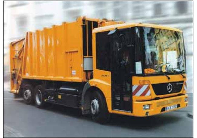
Der vorrangig im Kommunal-Bereich eingesetzte Mercedes-Benz Eonic mit Niederflur-Fahrerhaus präsentiert sich auf der IAA Nutzfahrzeuge 2006 in Hannover mit neuer Frontgestaltung im Kühlerbereich. Eine neue Hinterachse hat jetzt 13 Tonnen statt bisher 11,5 Tonnen. Tragfähigkeit und modifizierte Stoßdämpfer führen zu einer verbesserten Fahrstabilität und Spurtreue. Bild: DaimlerChrysler
