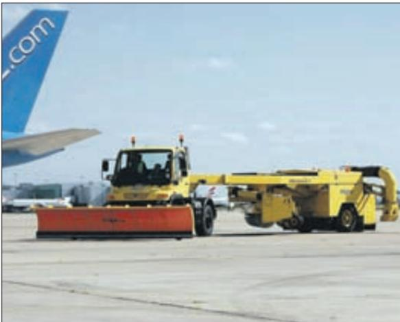
Ein Schneepflug und eine Anhängerekehrmaschine, montiert auf einem Mercedes-Benz Unimog 500, sorgen für eine freie Start- und Landebahn am Flughafen London-Gatwick.
