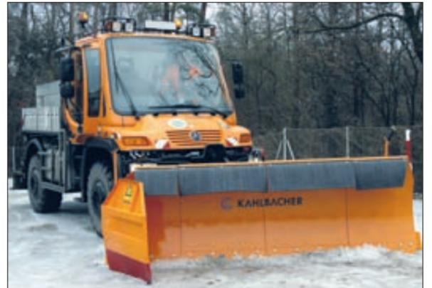
Die Räumung von Kreuzungen, Kreisverkehren, ÖPNV-Haltestellen und Einfahrten im Siedlungsbereich wird erheblich sicherer und einfacher durch die Auswurfsperrung bei den Kahlbacher Seitenschneepflügen. In Sperrstellung liegt die Auswurfsperrung mit der Räumleiste in Fahrtrichtung auf der Fahrbahn auf und verhindert den Schneeaustritt. Beim Öffnen schwingt der Flügel nach oben weg. Der Schnee kann sofort abfließen. □
