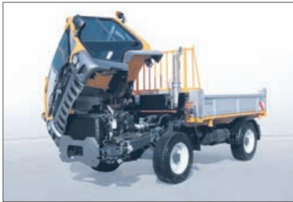
Die Komfortkabine des Unitrac ist ohne Zuhilfenahme von Werkzeug um 50 Grad kippbar.
