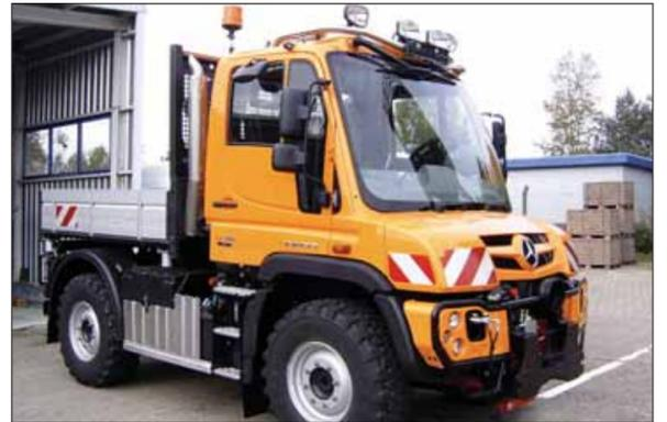
Der neue Unimog U 318 am BImA-Handwerkerstützpunkt (Bundesanstalt für Immobilienaufgaben) des ehemaligen Grenzübergangs Pomellen ist ein wendiger und leistungsstarker Dreiseitenkipper. Mit EasyDrive, Frontanbauplatte, Frontzapfwelle, Arbeitsscheinwerferanlage sowie Kugelkopf- und Lkw-Anhängerkupplung erlaubt er Ganzjahreseinsätze bei Pflege- und Unterhaltungsarbeiten mit wechselnden alten und neuen Geräten. □
