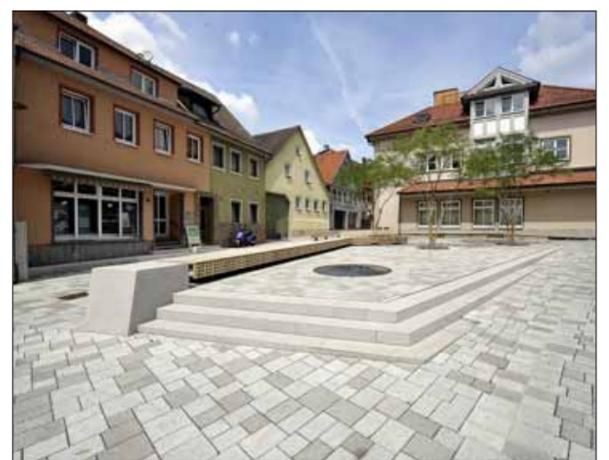
Wilder Verband: Belgrano-Pflastersteine in drei abgestuften Farben und zehn unterschiedlichen Formaten wurden in einem unregelmäßigen Muster verlegt, was die Fläche des Linsenbrunnenplatzes auflockerte. □
