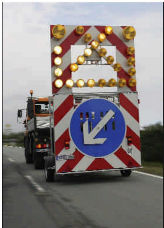
Gefahrenmoment: Der Unimog mit Warnanhänger soll die Baukolonne schützen.
