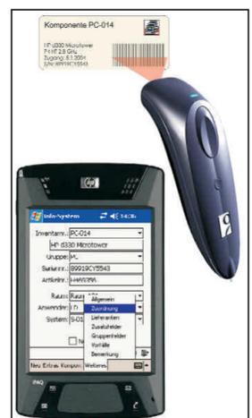
Ein handlicher Scanner liest den Barcode eines Inventar-etiketts und überträgt die Daten drahtlos zum Pocket PC.
