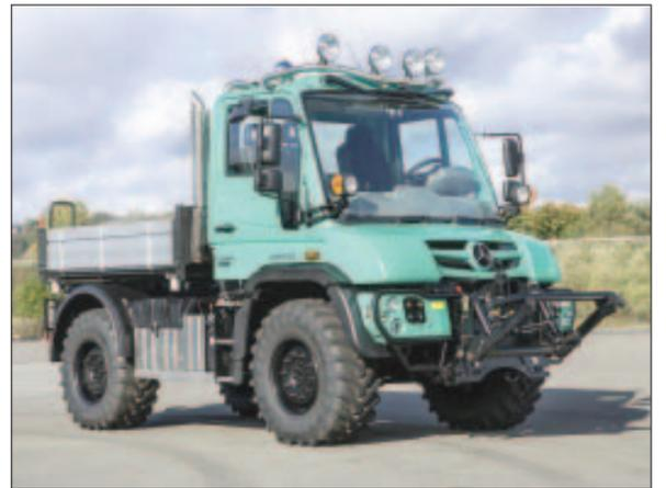
In Hannover wurde auf der Agritechnica ein neuer Unimog U 423 in Agrarausstattung gezeigt. Diese ist geprägt durch die spezielle Pritsche, die Agrarbereitung, die neu konzipierte mechanische Heckzapfwelle sowie Front- und Heckkraftheber. Die Kombination ist zugeschnitten sowohl auf den Transport wie auf Feldarbeiten. □
