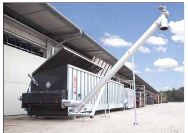
Der Schubkeilbodentrockner von Fliegl zeichnet sich durch eine konsequent robuste Konstruktion aus: Das Gehäuse entspricht in Abmessungen und Aufbau einem ISO-Container.
