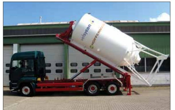
Der Combilift kann seinen Aufnahmehaken horizontal über die gesamte Gerätelänge teleskopieren und bietet damit mehr Möglichkeiten als jeder andere Abrollkipper am Markt.
