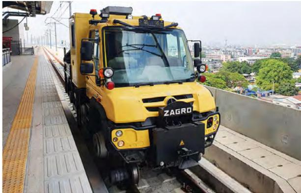
Zwei Zweibege-Fahrzeuge Unimog U 423 mit einer Schienenführungseinrichtung der Zagro Bahn- und Baumaschinen GmbH führen Wartungs- und Instandhaltungsarbeiten an der neuen Metrostrecke Red Line in der thailändischen Metropole Bangkok durch. Bild: Daimler Truck
