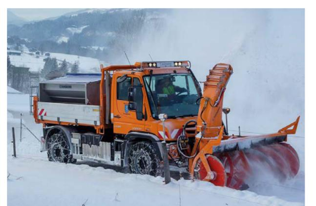
Unser Bild zeigt nicht den U 527 aus dem Wettbewerb in Stolpe – und auch keinen normalen Schneepflug. Aber dieser neue Unimog U 430 leistet in Leogang im Salzburger Land hervorragende Arbeit im Winterdienst. Technische Daten: Mercedes-Benz Unimog U 430, Exterieur, orange, OM 936 Euro VI mit 220 kW (299 PS), 7,7 l Hubraum, permanenter Allradantrieb. □
