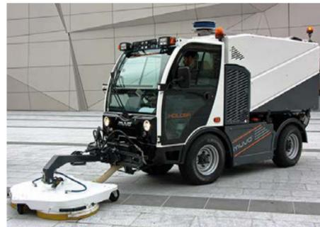
Holder MUVO mit CRISTAL CH 3000 HP Hochdruckreinigungsanlage und Absaugung.
