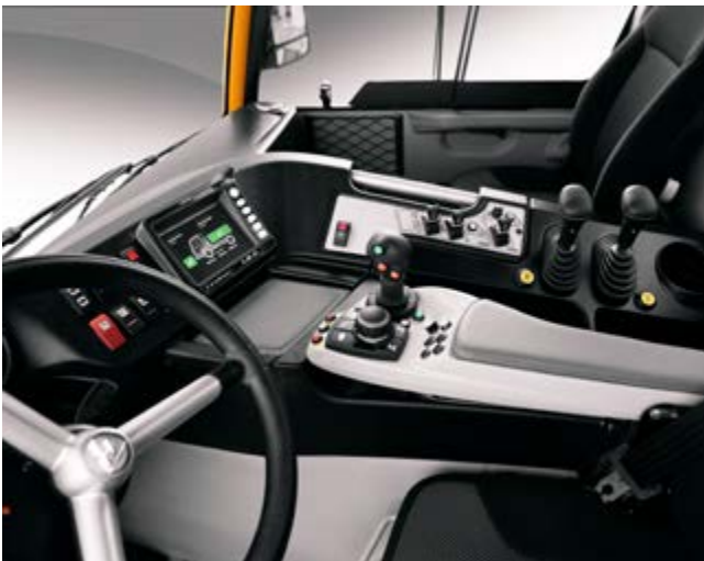
Das TracLink erkennt Geräte, die angebaut werden, und unterstützt dabei, die richtige Einstellung zu finden.
