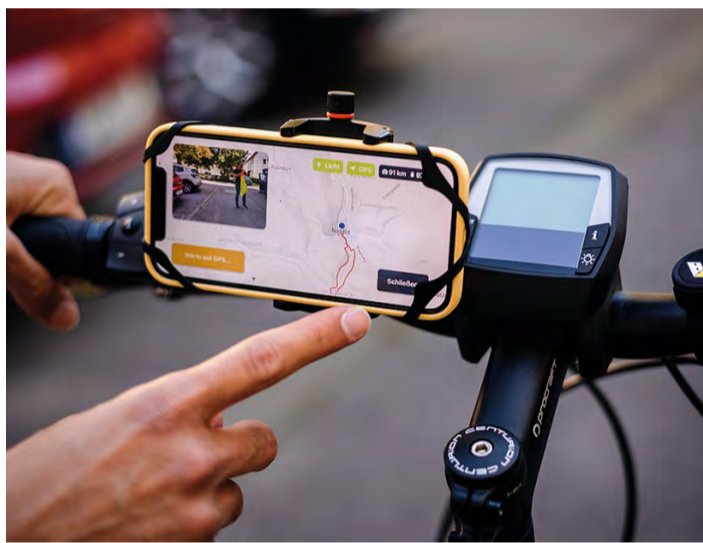
vialytics Smartphone-Zustandserfassung am Fahrradlenker.
