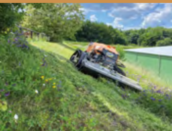
Funkferngesteuerte Mähraupe mit Grasschneidewerk (oben) und mit einem Anbaugerät zur Aufnahme des Mähguts (unten). Foto: KLP Baumaschinen GmbH
