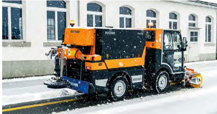
Bucher Kehrmaschine CityCat V20e mit vollelektrischen Streuautomaten Husky L14e.
