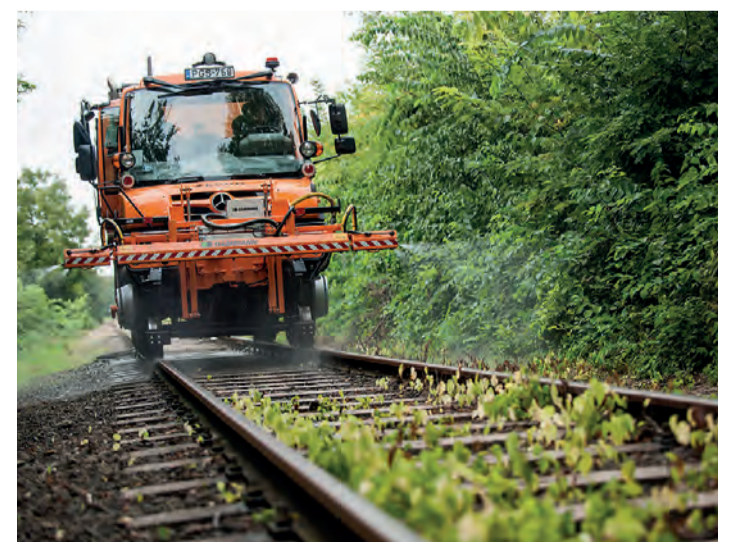
Zur Instandhaltung Ihres Schienennetzes erwarb die Ungarische Staatsbahn (MÁV) neun Mercedes-Benz Unimog U 423 für den Einsatz auf Straße und Schiene. Die 2-Wege Unimog für Straße und Schiene sind mit verschiedensten Geräten kombinierbar, wie beispielsweise einer Dammann-Gleissprühanlage (unser Bild). □
