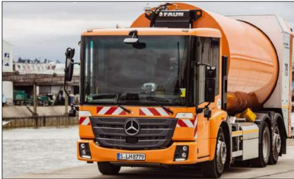
Der Mercedes-Benz Eonic NGT im Einsatz bei AWS Abfallwirtschaft Stuttgart. Technische Daten: Mercedes-Benz Eonic NGT, Euro VI Erdgasmotor M 936 G mit 7,7 l Hubraum, 222 kW (302 PS), zulässiges Gesamtgewicht von 26 t, Radstand 3900 mm.
