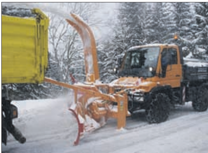
Seitenschneefräse beim Schneeverladen auf LKW. □
