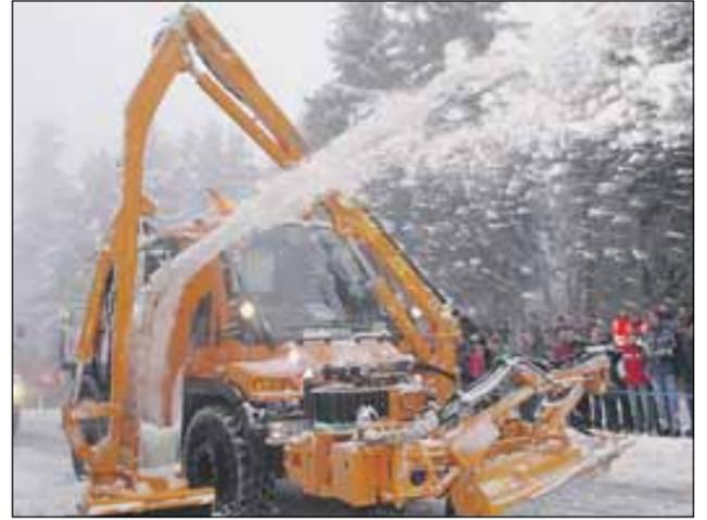
Verblüffender Effekt beim Unimog: Kleine Schneefräse am Kombigerät von Mulag.
