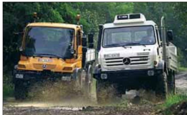
Links die Baureihe U 300-500 (Geräteträger), rechts die hochgeländegängige Baureihe U 3000-5000.
