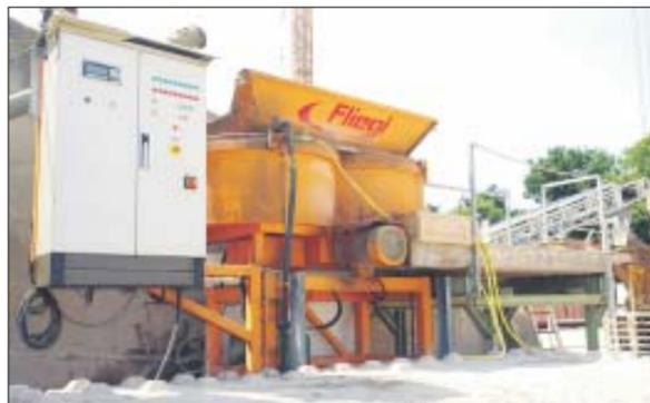
Der Duplex-Mischer „DMA“ ist ein komplettes, mobiles Betonmischwerk, das sehr kompakt und modular aufgebaut ist. □
