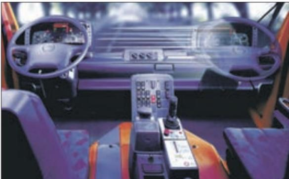
Einmalig und nur beim Mercedes-Benz Unimog Geräteträger (U300-U500) verfügbar: VarioPilot, die Wechsellenkung für den wirtschaftlichen Einmann-Betrieb. □
