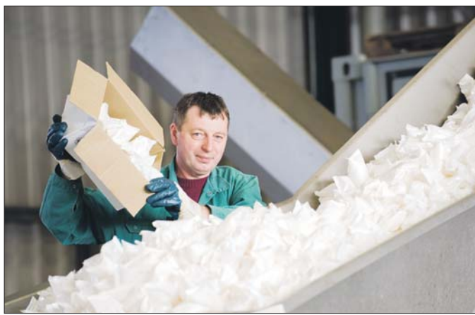
Mitarbeiter Detlef Zippel füllt kleine Eispackchen in die Entpackungsanlage. Beim Vergären in der Anlage bilden Bioabfall und Gülle Methan.
