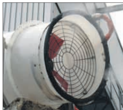
Bis der Erweiterungsbau des Holzbunkers fertig ist, helfen Nebelbedürfnisse die Staubentwicklung einzudämmen.
