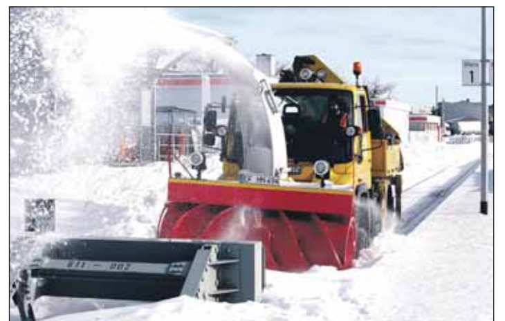
Im Winter versinken auch Bahnhöfe oder Trambahngleise im Schnee. Kein Problem für den 2-Wege-Unimog, wird aus ihm doch schnell eine Schnee-Räummaschine mit Schneefräse, Keil-Schneepflug oder zapfwellengetriebener Vorbau-Kehrmaschine. □
