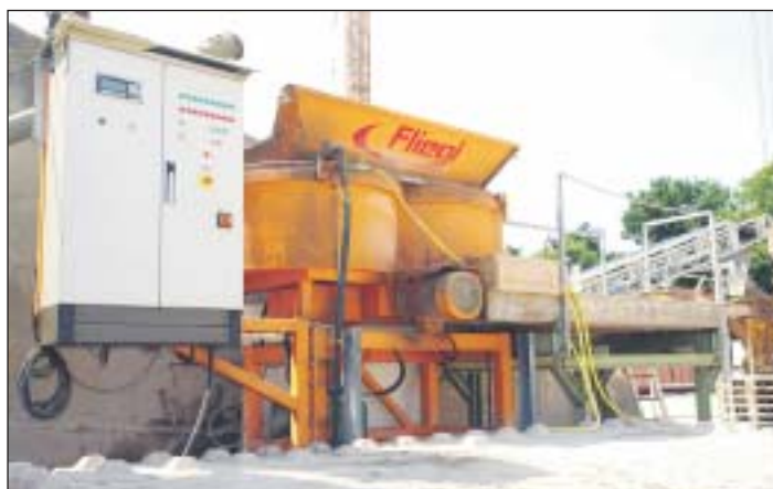
Der Duplex-Mischer „DMA“ ist ein komplettes, mobiles Betonmischwerk, das sehr kompakt und modular aufgebaut ist. □
