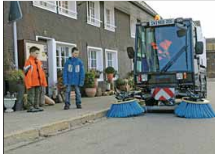
Auf innerstädtischen Straßenzügen und Plätzen fällt mehr Schmutz an, der sich aus dem fahrenden Verkehr ergibt. Lange Einsatzzeiten, Vierrad-Lenkung und eine große Aufnahmekapazität sind Merkmale der SWINGO 200.
