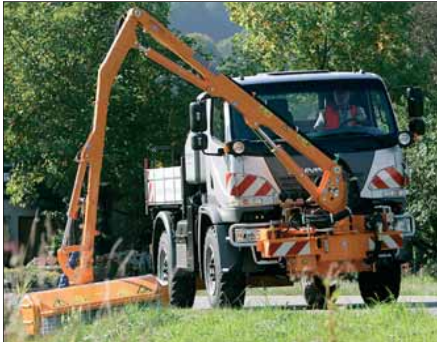
rigen Preis. Beim zulässigen Gesamtgewicht liegt der U 20 zwischen 7,5 und 8,5 Tonnen, die Achslasten sind mit 4,8 Tonnen zur Aufnahme von Anbaugeräten gut bemessen. Auf den Bildern ein Modell mit Frontausleger-Böschungsmäher. □
