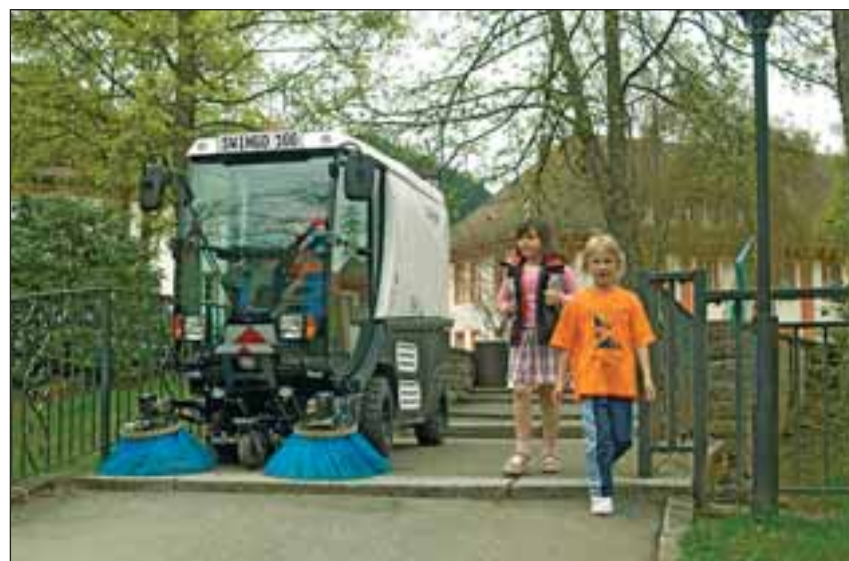
Den täglichen Wohlstandsmüll im Fußgängerbereich beseitigt die SWINGO 100: Getränke Dosen, Verpackungen von Süßigkeiten und die Reste von Fast-Food-Restaurants oder Imbissbuden: Essensüberbleibsel und Plastikbestecke. Das Geräte verfügt über zwei individuell zu steuernde Tellerbesen. Bürgersteige, Ecken und vergleichbare Flächen kehrt sie zuverlässig.
