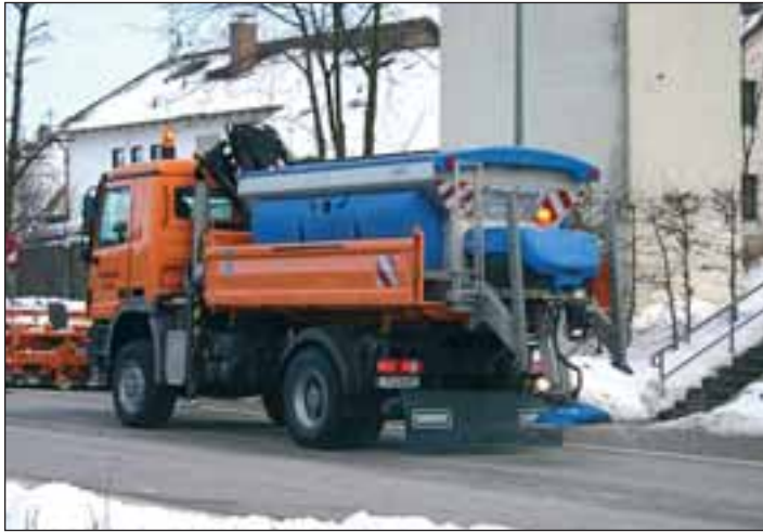
Beim Winterdienst in München kommt u. a. diese Streu- und Räumkombination zum Einsatz. Die Streumaschine aus der STRATOS-Serie der SCHMIDT Winterdienst- und Kommunaltechnik GmbH leistet in der Landeshauptstadt gute Dienste. Bild: Werkfoto SCHMIDT
