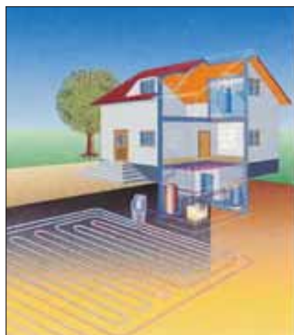
Erdwärmekollektoren sind Wärmetauscher, die nur 0,2 m unterhalb der Frostgrenze (ca. 1,0 bis 1,2 m) verlegt werden.
