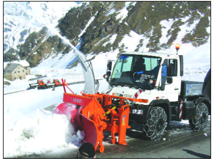
Die Seitenfräse SF-Z der Schmidt Winterdienst- und Kommunaltechnik GmbH in St. Blasien, angebaut an einen U 400, ist ein Beispiel für den effektiven und rationellen Einsatz rotierender Schneeräumgeräte, wenn die Bedingungen extreme Verhältnisse wie Verwehungen oder komplett zugeschüttete Straßen nicht einschließen. Alles andere bewältigt die Seitenfräse souverän, die Beseitigung von Randwällen ist ihr Spezialgebiet. Fotos: Bertele
