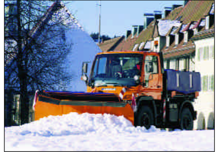
Der Unimog U 400 mit einer Winterdienst-Arbeitskombination aus Schneepflug und Streuer des Unimog-Geräte-System-Partners Gmeiner.
