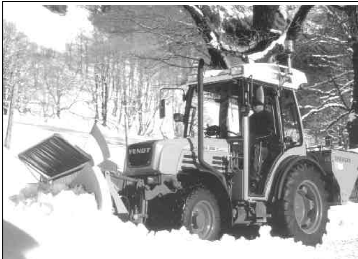
Fendt-Schmalspurtraktoren 200 V/P sind auf Mäh-, Pflege- und Winterdienstarbeiten spezialisiert. Sie sind robust, zuverlässig, wertbeständig und mit einer hohen Auslastung wirtschaftlich im Einsatz. Foto: AGCO/Fendt
