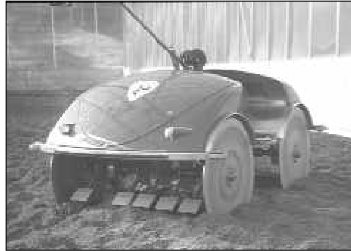
Das „elektrische Schwein“ ist das Kernstück der solaren Klärschlamm Trocknung von Thermo-System. Der kleine Roboter sorgt für optimale Entlüftung des Klärschlammes.
